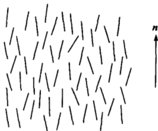
图 3.10 向列型液晶示意图
